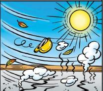
Trhliny od plastického smršťování vznikají v důsledku rychlého vypařování vody z povrchu betonu.
