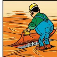
Nebo udržuj povrch betonu mokrý a zakryj ho fólií nebo rohožemi.
