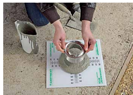
6. Zkouška rozlivu – konzistence cementového potěru CEMFLOW
