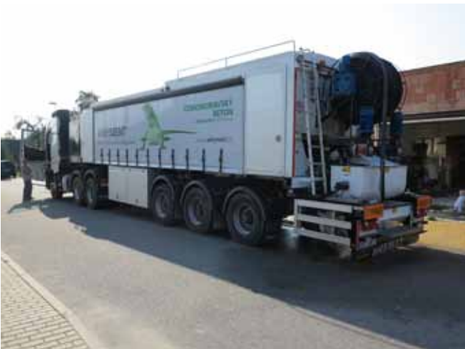
■ ANHYMENT® - mobilní výrobní zařízení na stavbě
